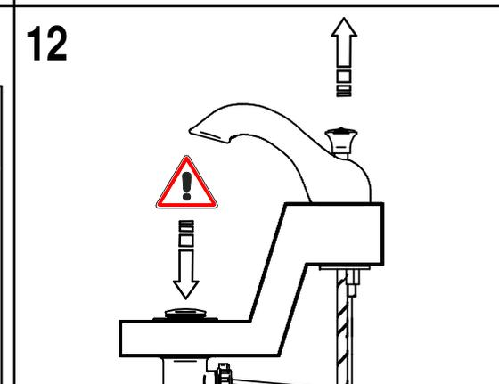
**SOSTITUZIONE VITONE / VALVE REPLACEMENT**
